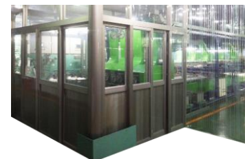
密閉隔間 防止冷氣洩漏
